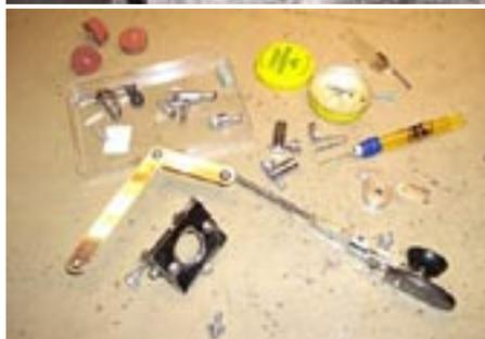
Dags att montera ihop buggen igen. Jodå. Alla smådelarna passade ihop och inget blev över. Fjädrarna fick en droppe olja som rostskyddsbehandling. Vaseline användes för de justerbara skruvarna och friktionslagren
